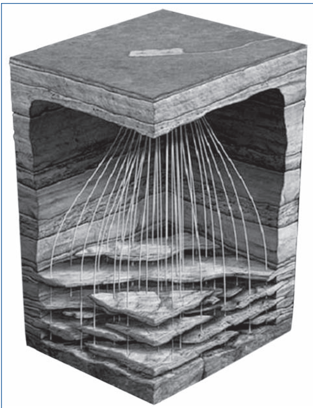
Схема буріння великої кількості свердловин з одного майданчика
